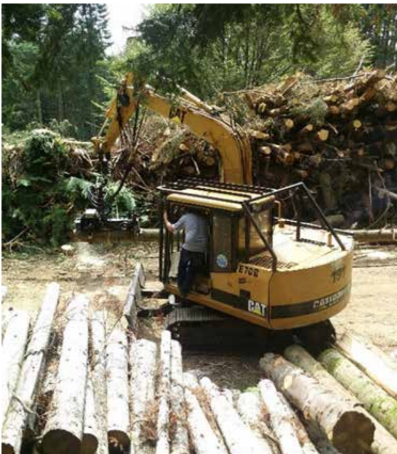
Fotografies 9 i 10. Exemple d'excavadores dedicades a auxiliar cables aeris. A l'esquerra una màquina amb grapa equipada amb motoserra carregant llenya anteriorment trossejada i apilada durant la saca i a la dreta, una petita processadora forestal instal·lada en una excavadora de 7 tones.
