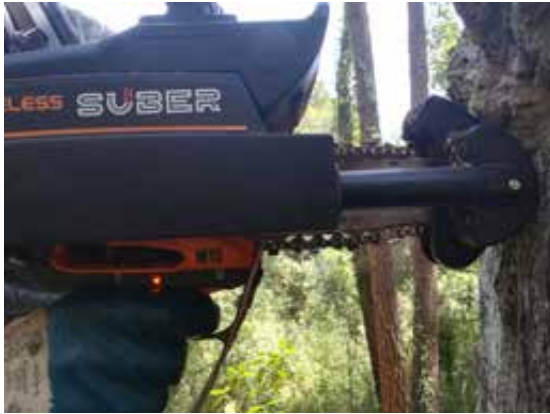
Fotografia 2. Prova del prototip de la màquina Coveless 3C18, a la part de la dreta es pot veure el protector per controlar la profunditat de tall amb el sensor incorporat. Foto de CFC
