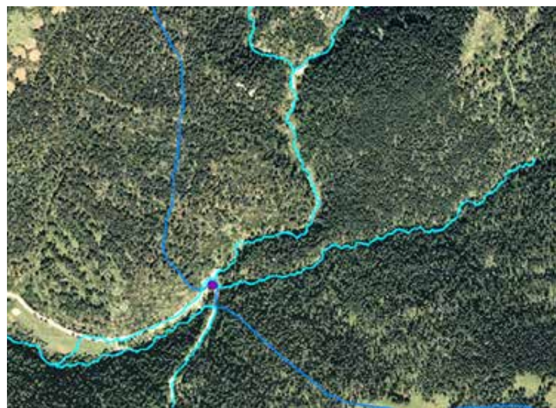
Figura 4. S'observa en color blau fosc el límit de la conca i en color blau clar el recorregut dels cursos d'aigua calculats a partir de MDE de la zona. S'observa que el curs d'aigua circula un tram pel camí. Aquest tram és el que ha patit les fortes erosions de la caixa de manera recurrent (Figura de Montserrat Solanelles sobre ortofoto de l'ICGC).(color blau) amb la localització del pas de la pista a la llera com a punt d'actuació. Figura de Montserrat Solanelles, sobre ortofoto de l'ICGC.
