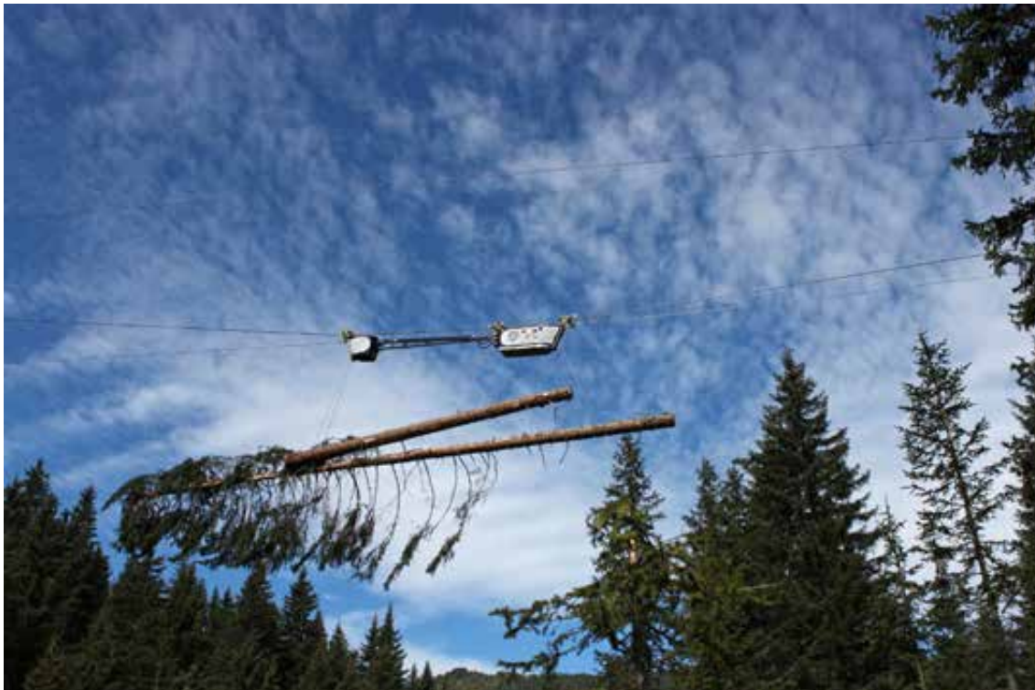
Fotografia 6. Carro de doble enganxament traient un arbre sencer en dues rolls, a un aprofitament als Alps italians.
