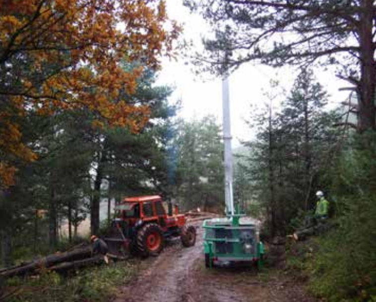
Fotografia 3. Cable aeri model SIBERIAN utilitzat a la experiència de Pont de Suert.
