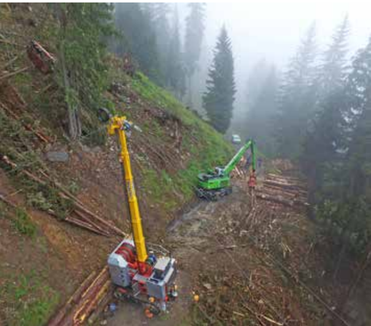
Fotografia 1. Sistema de cable aeri tricable amb el model V850 de la marca Velentini Teleferiche.
