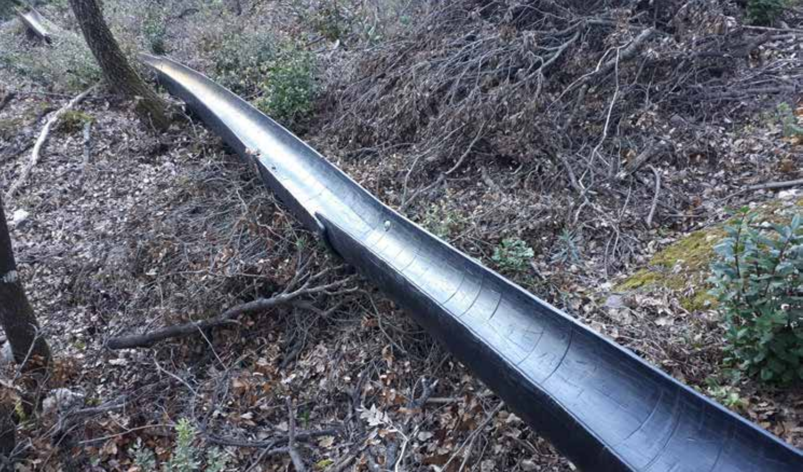
Fotografia 1. Desembosc per canals a Mura (Bages) amb tubs de fabricació pròpia. Febrer 2019.
