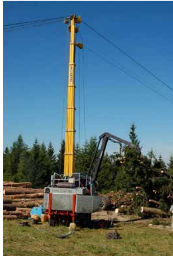
Fotografia 7. Processadora forestal (en segon pla) desbrancant i trossejant arbres sencers trets amb cable aeri.
